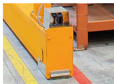
Systém zjišťování překážek na spodním nosníku pojezdového ústrojí
