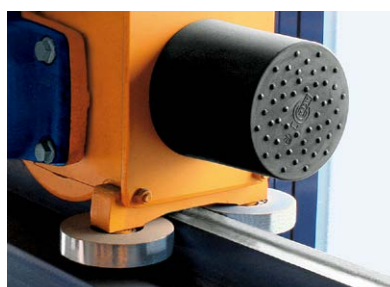
Vodící kladky na horním nosníku pojezdového ústrojí
