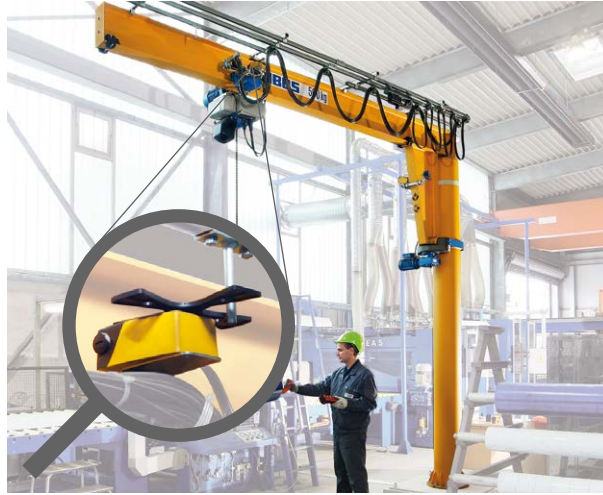
Mezní spínač pojezdu kočky (obrázek 8)
