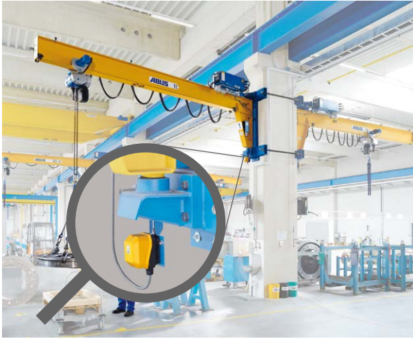
Mezní spínač otáčení VW (obrázek 7)
