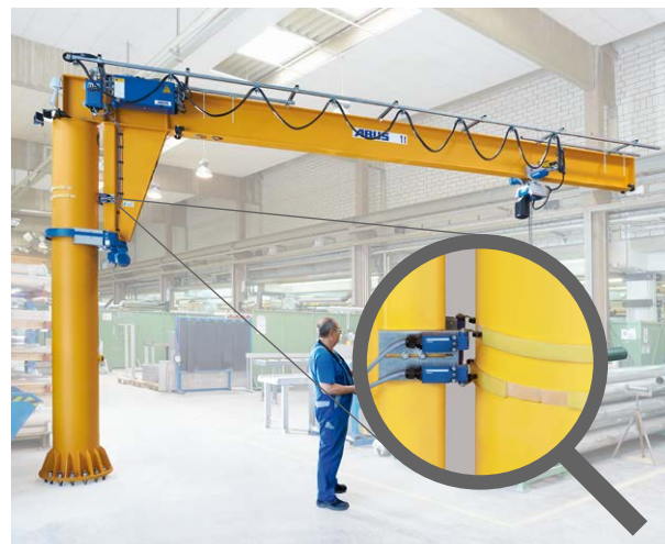
Mezní spínač otáčení VS (obrázek 6)
